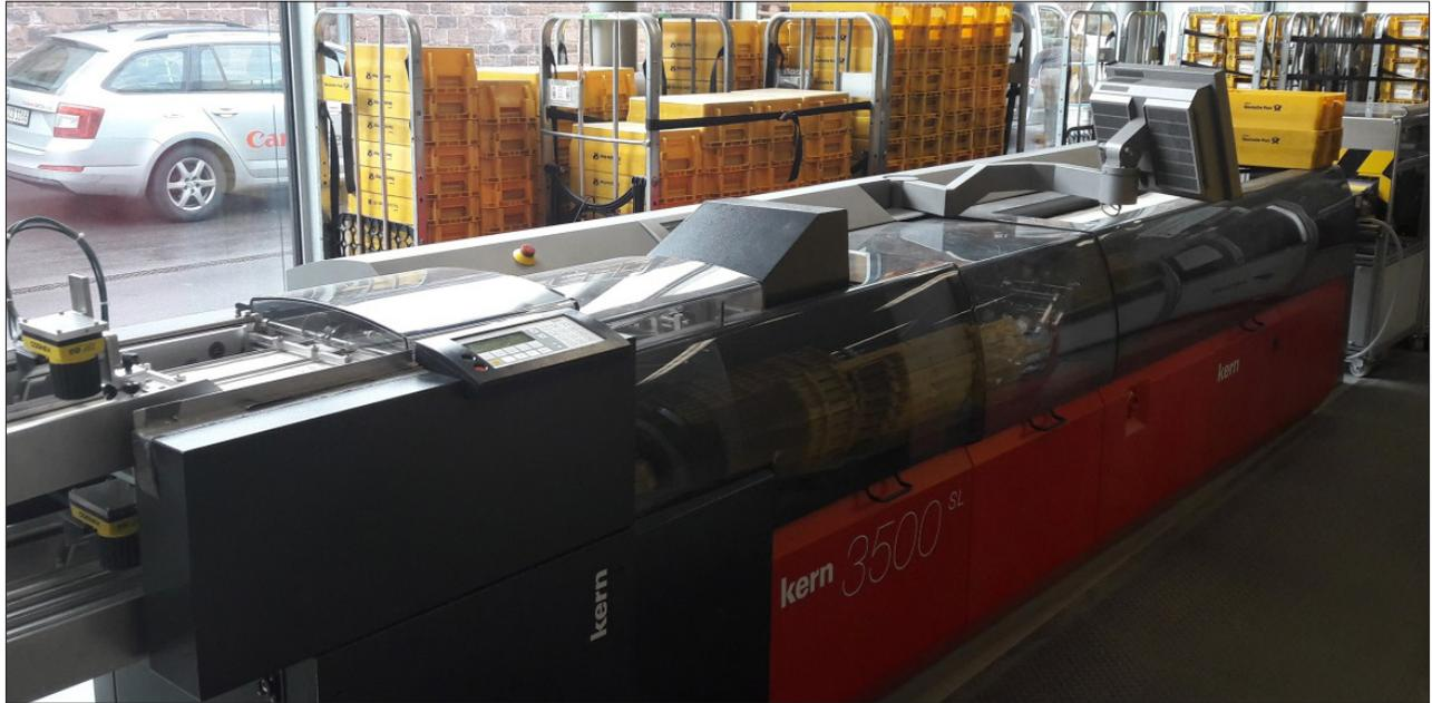
Hochleistungskuvertieranlage im Druck- und Versandzentrum
