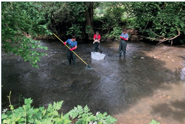
Abb. 24: Schonende Entnahme der Fische mittels Elektrofischerei.
